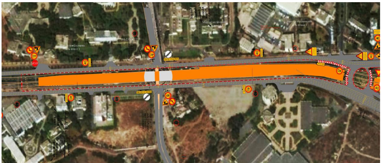
Aménagement provisoire de la zone de chantier
